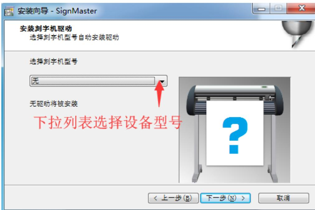
备注：绿眼或者红点机型如 CA1200 软件对应选择 CA1300，摄像头机型如 CY1200 软件对应选择 CY1200，私服电机机型如 CS1200 软件对应选择 CS1200。具体设备型号以外包箱上备注型号为参考。
